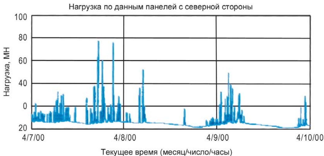
Рис. 2. Действие глобальных ледовых нагрузок в течение времени эксперимента [3]
