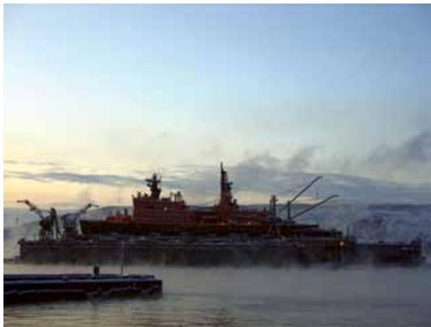
Атомный ледокол в плановом ремонте в плавдоке завода для освидетельствования корпуса, донно-заборной арматуры и винто-рулевого комплекса
