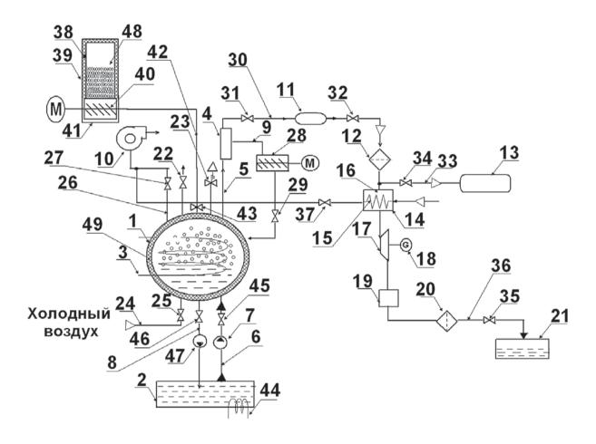
Рис. 1. Схема установки для получения из гидрата метана разовой партии газообразного и жидкого метана
