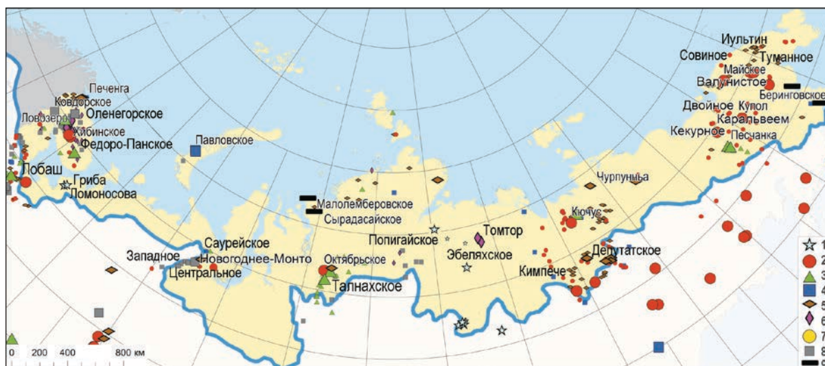
Рис. 2. Размещение месторождений твердых полезных ископаемых в российском секторе ЦАП (по данным ГИС-анализа): 1–9 – месторождения твердых полезных ископаемых: 1 – алмазов, 2 – благородных металлов (Pt, Pd, Au, Ag), 3–5 – цветных металлов: 3 – Cu-Mo, 4 – Zn-Pb, 5 – Sn-W, 6 – редких металлов (РЗМ, Nb, Ta и др.), 7 – урана, 8 – черных металлов (железных и хромовых руд), 9 – угля
